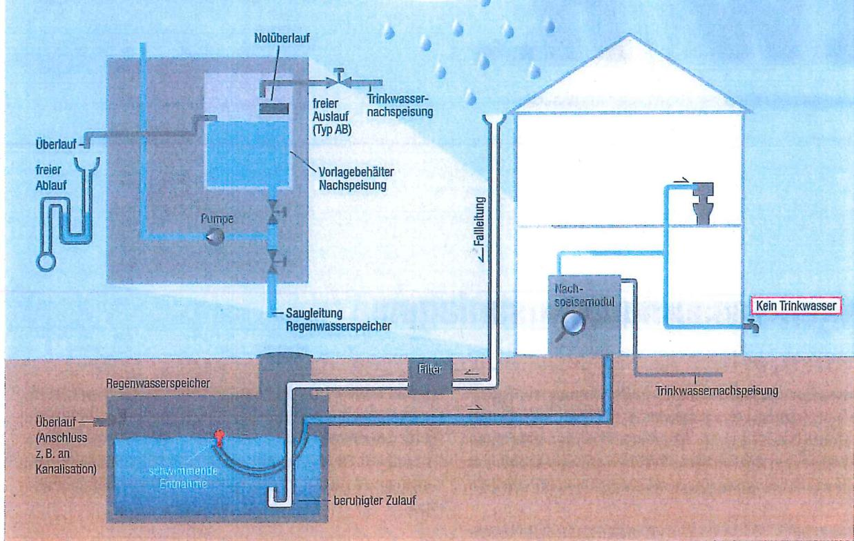
Abbildung 1: Einbau des freien Auslaufes zwischen Regenwassernutzungsanlage und Trinkwassernachspeisung (dargestellt ist der freie Auslauf Typ AB; möglich ist auch der Typ AA und AD, siehe DIN EN 1717)
